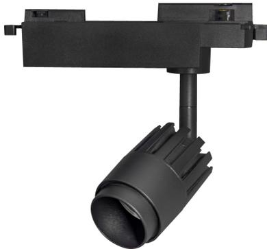
Luminario de montaje en riel monofásico de tres pistas, fabricado en fundición de aluminio, acabado en color negro, led tipo COB, driver multivoltaje.
