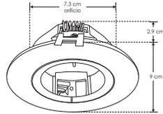
**NOTA:** No es necesario desmontar el difusor para realizar el cambio de la lámpara, se hace por la parte inferior.
