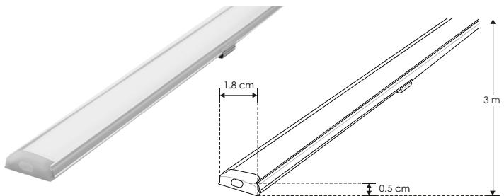
**Material** Kit de perfil de aluminio sin ceja, rectangular flexible acabado natural de sobreponer o suspender de 3 m de largo, para recibir tira extraplana de LEDs
